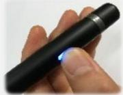
펜의 전원이 켜지면 진동모터가 잠깐 동작되고 상태 LED가 빨간색과 파란색으로 교대로 점멸되면서 연결대기 모드(상태)가 됩니다.
